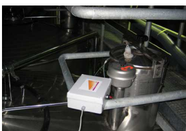
Figure 1 : suivi du potentiel rédox libre à 3 niveaux de hauteur sur une cuve au cours de la fermentation alcoolique et de la macération
