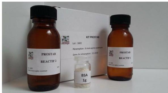
La méthode est basée sur une réaction spécifique sur les protéines qui provoque un trouble. L'intensité du trouble est proportionnelle à l'instabilité protéique du vin. Elle peut être utilisée en manuel ou en automatique sur séquentiel (réactifs différents)
